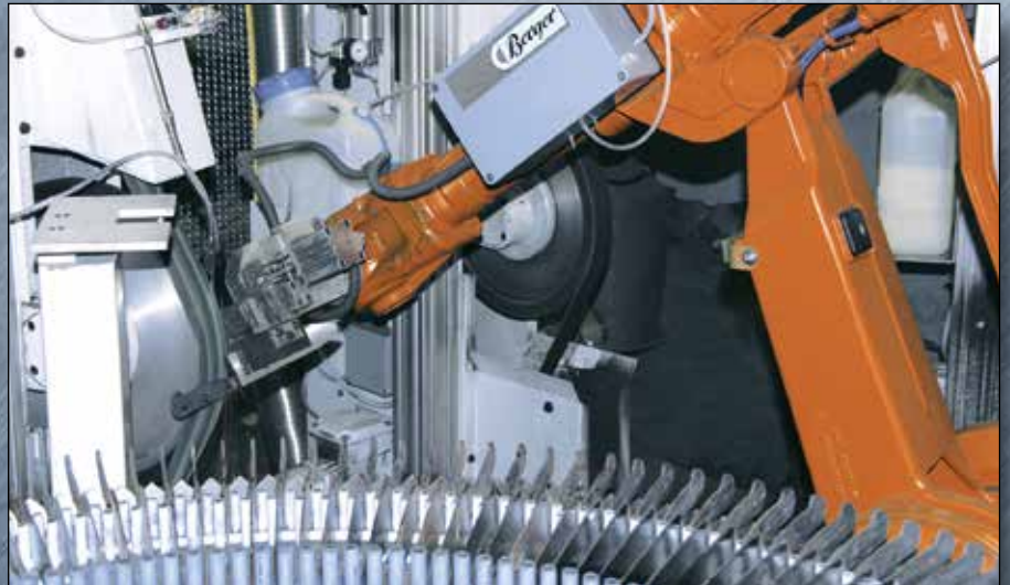
Hochmoderner Roboter für die Kropfbearbeitung im Hause Burgvogel Modern robot for bolster grinding
